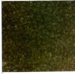
Gambar 4. Lapisan Titania pada plat kaca yang dibuat dari larutan Titania 0,75 M (5 kali pelapisan) dengan 15 kali perbesaran
