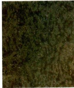
Gambar 5. Lapisan Titania pada plat kaca yang dibuat dari larutan Titania 1,0 M (4 kali pelapisan) dengan 15 kali perbesaran
